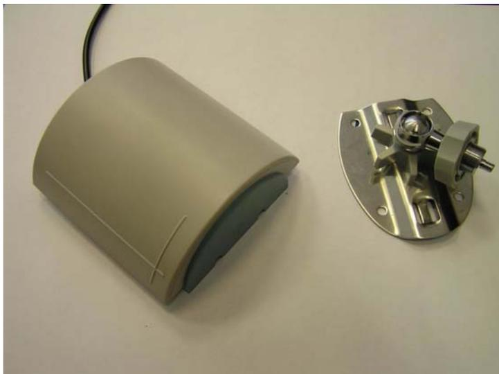
Рисунок 2. Выносная антенна для считывателя.
