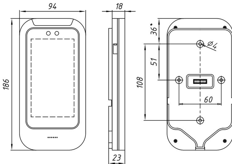
Рис. 2. Размеры и крепёж терминалов R20-Face (5W) Lite
