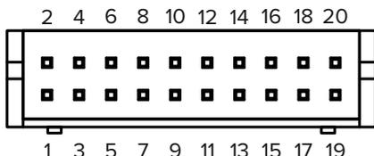
Рис. 9. Расположение контактов шлейфового разъема
