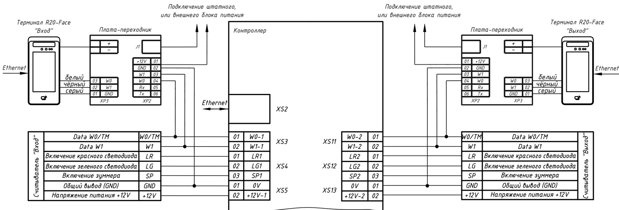
Схема подключения терминала R20-Face (5W/Lite) к контроллеру
