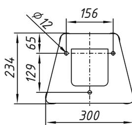
Рис. 8. Размеры напольной стойки для монтажа терминалов
