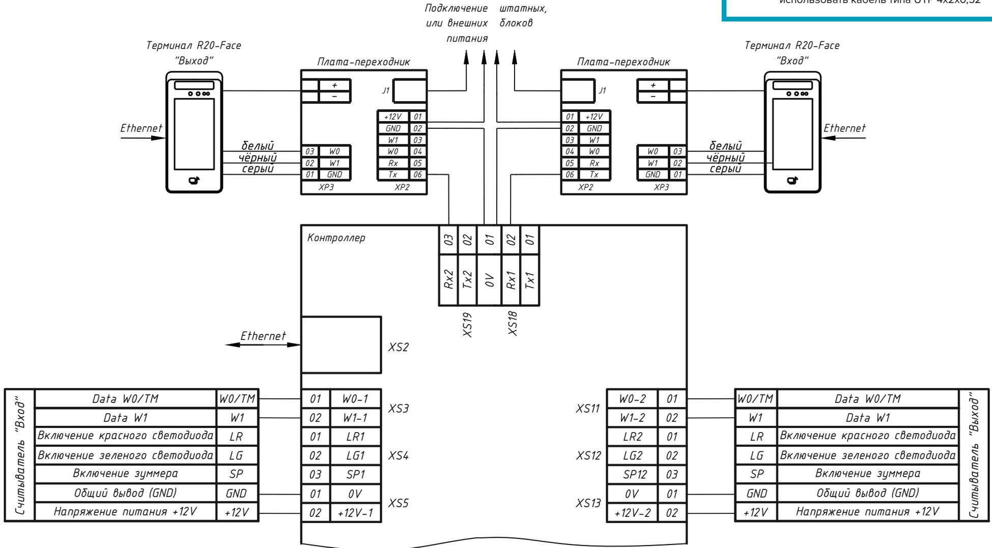
При питании терминала от внешнего источника питания рекомендуется использовать кабель с сечением не тоньше, чем ШВВП 2х1,5 или аналог. После включения терминала убедитесь, что напряжение на нем равно 12–12.2 В. Если напряжение меньше, повысьте его на источнике питания либо используйте кабель с большим сечением.
