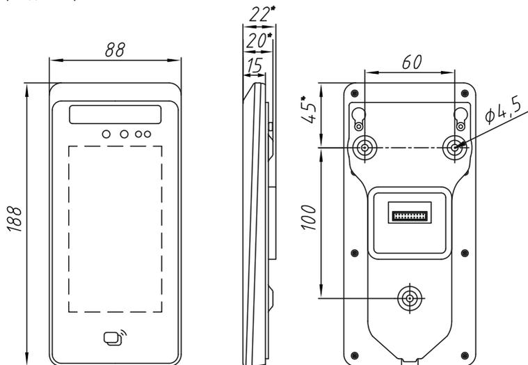
Рис. 1. Размеры и крепёж терминалов R20-Face (5W)
