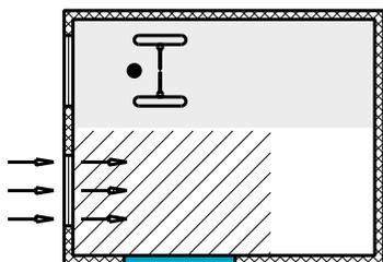
В помещениях (без окна), с доступом света через дверь, терминал рекомендуется установить в месте без сильного затенения с умеренной освещенностью.
