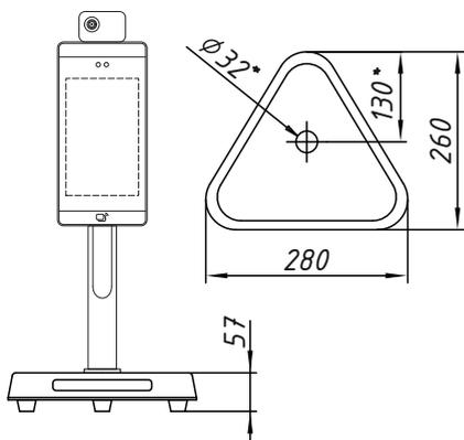
Рис. 7. Размеры настольной опоры для монтажа терминалов
