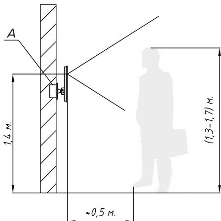
Для дальнейшей комфортной коммутации терминала при монтаже проводки максимальные габариты монтажного отверстия (A) в стене должны быть выбраны ориентируясь на размеры в таблице.
